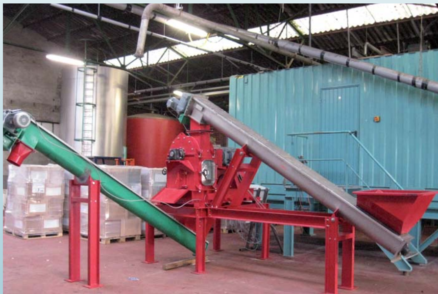
De Martinater 500 vermaalt shop returns, restaurant returns en andere levensmiddelen zodat ze geschikt zijn voor recycling en/of biogas toepassingen.
